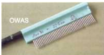
M = 22,5 Nm: Kein Bruch, nur leichte Versetzung der Nadeln
